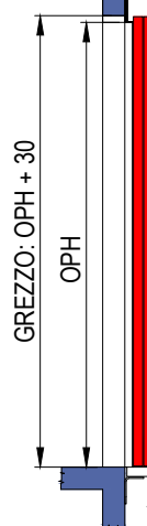
SEZIONE PORTE SENZA TELAIO (E1120)
